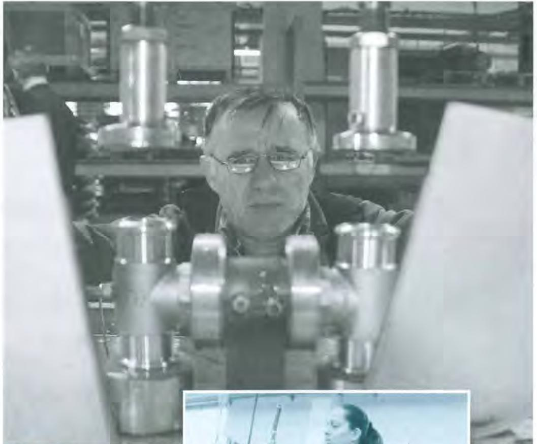
**Alles dicht:** Konstandinos Goulas versenkt die Gussteile in ein Wasserbecken. Steigen Luftbläschen auf, wird aussortiert.
