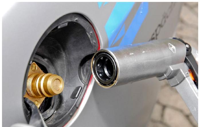
Da es keinen Benzintank mehr gibt, kann das Gegenstück zum Euronozzle im HTW-Versuchsfahrzeug dauerhaft unter der Tankklappe platziert bleiben.
