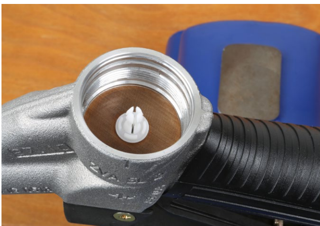
Rollen der Membrangarnitur müssen beim Einsetzen in die Zugstangengarnitur einrasten. Ensure that rolls of diaphragm assembly snap into pull rod assembly.
