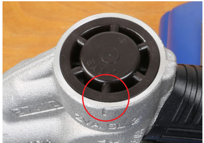
Eine der sechs Rippen an der Gehäusemarkierung ausrichten. Align one of the six ribs with body marking as shown.
