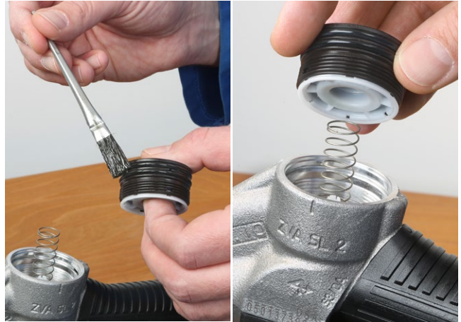
O-Ringe EO 271 einölen. Lubricate O-rings EO 271.
