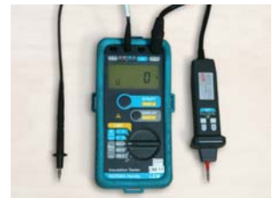
Insulation Tester (500 V d.c.): used for measuring 'Ohm' hoses (EN ISO 8031)
