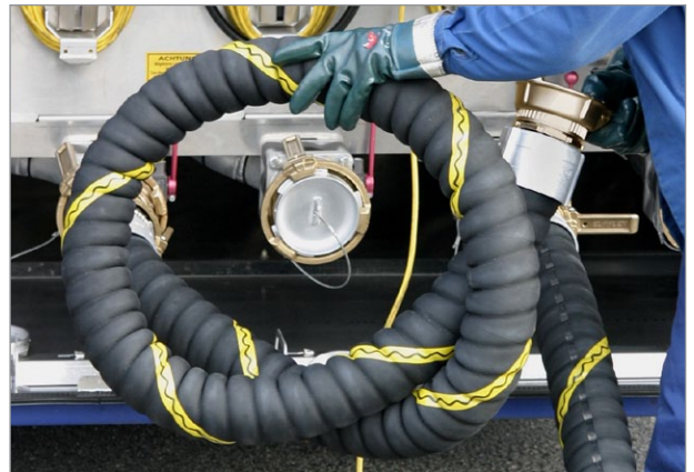
Kennzeichnung : Gelbe Spiralmarkierung und Prägebandstempelung LTX 80 · NBR · SCHWERKRAFT / GRAVITY · Ω · PN 4 BAR · ELAFLEX © 05.14
