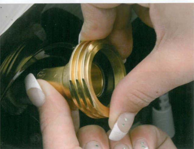
Geht schon ganz gut: Beim Opel Corsa lässt sich der Tankadapter wegen der Länge gut festschrauben.
