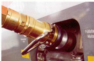
Bild 8: Adapterlösung bei der BR 642
