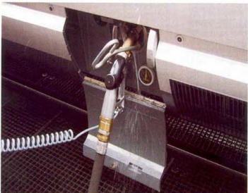
Bild 6: Kraftstoffaustritt bei der Befüllung
