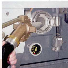
Bild 3: Zapfventil im offenen System
