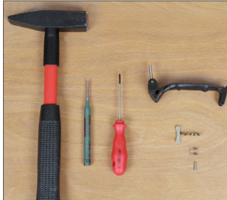
Werkzeuge: Hammer, Splintreiber (zur Demontage), kleiner Schlitzschraubendreher
