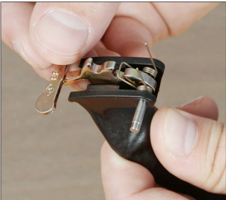
Aufhalteraste EF 033.1 und Feder EF 032 einlegen und am Bolzen ausrichten.
