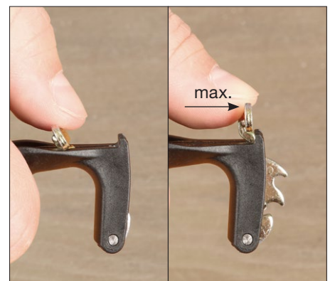
Funktionsüberprüfung: Aufhalteraste muss zurückspringen. Nicht überdehnen!
