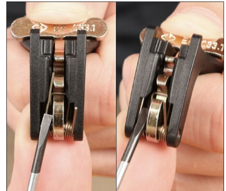
Federstege mit Schraubendreher wie gezeigt einhaken ...
