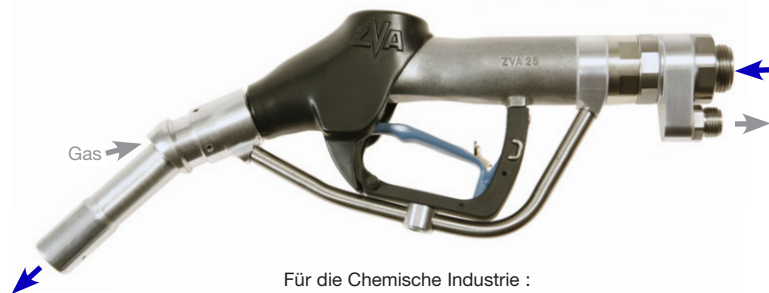
Für die Chemische Industrie : automatisches Zapfventil ZVA 25 GR. Aktive, offene Gasrückführung für Lösungsmittel. Abgabeleistung max. 140 l/min.
