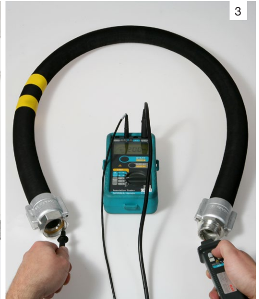
Fotos: 1) Schlauchmontage 2) Druckprüfung 3) Prüfung der elektrischen Leitfähigkeit 4) Unterflügelbetankung, HD-C 5) Unterflügelbetankung, HD-C 6) Oberflügelbetankung, ZVF 50 JET
