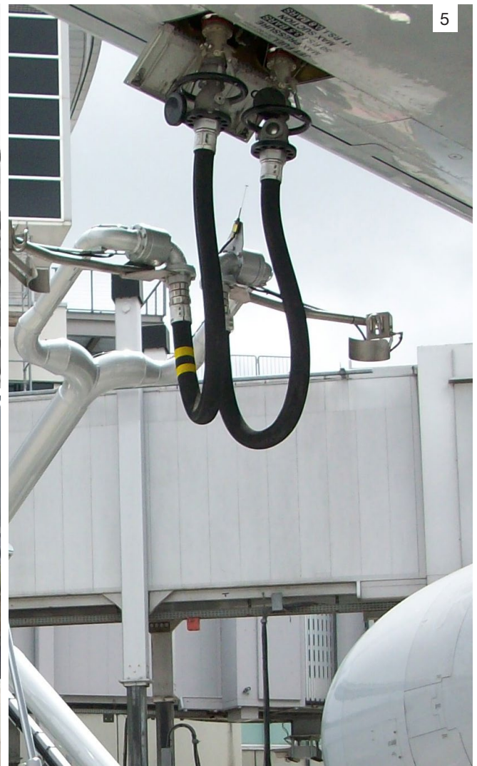
Fotos: 1) Schlauchmontage 2) Druckprüfung 3) Prüfung der elektrischen Leitfähigkeit 4) Unterflügelbetankung, HD-C 5) Unterflügelbetankung, HD-C 6) Oberflügelbetankung, ZVF 50 JET
