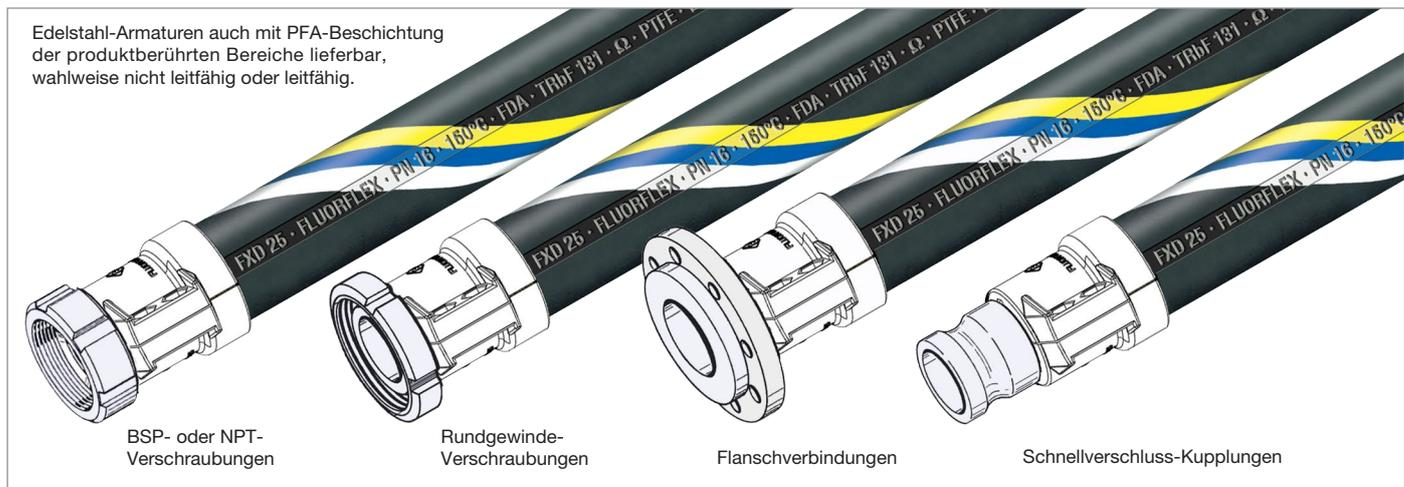
Eine detaillierte Montageanleitung (Mai 2009) kann angefordert werden. Alternativ zur Armierung mit Halbschalen ist auch eine Verpressung mit nicht demontierbaren Hülsen möglich.
