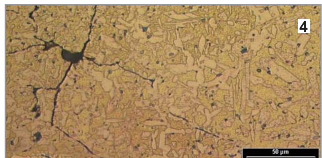
TW-Kupplung China: Risse und Poren nahe der Oberfläche
