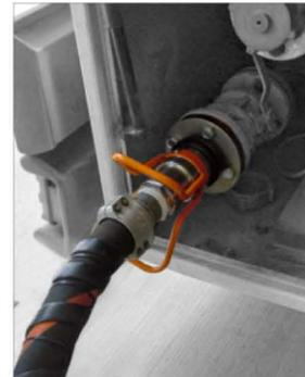
Be- und Entladung eines Straßentankers mit DGC Trockenkupplung und LPG-Schlauchleitung. (Foto: ELAFLEX)
