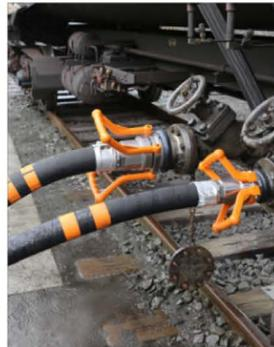
Be- und Entladung eines Flüssiggas-Kesselwagens mit DGC Trockenkupplungen und LPG-Schlauchleitungen. (Foto: ELAFLEX)
