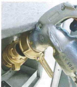
Enger Zugang: Anschluss des Zapfventils auf 'TWÜ 13' nicht direkt möglich
