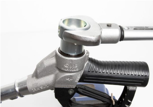
Mit Montagewerkzeug EW7 Einschraubdeckel einschrauben und mit 11 bis 13 Nm anziehen. Use tool EW7 to tighten the cap with 11 to 13 Nm.
