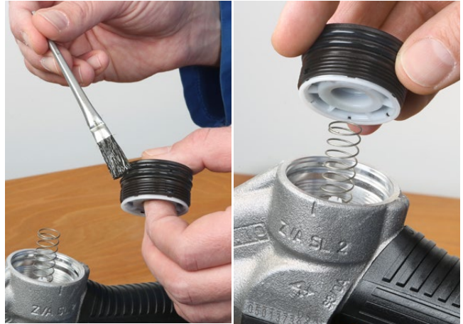
O-Ringe EO 271 einölen. Lubricate O-rings EO 271.
