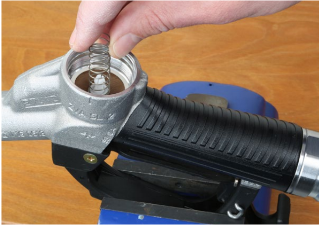
Feder zentriert auf Membrangarnitur aufsetzen. Insert centered spring onto diaphragm assembly.
