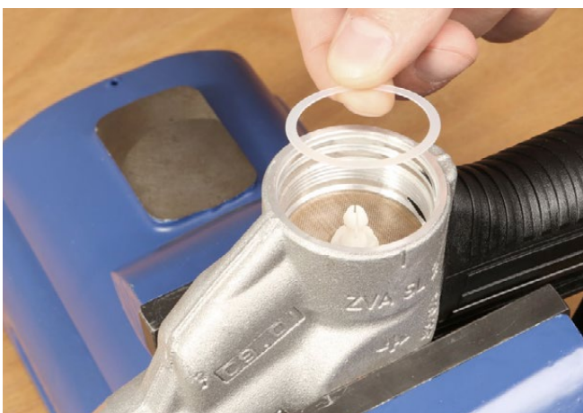
Rollen der Membrangarnitur müssen beim Einsetzen in die Zugstangengarnitur einrasten. Distanzscheibe EU 137 auf die Membrane legen. Ensure that rolls of diaphragm assembly snap into pull rod assembly. Lay spacer washer EU 137 onto membrane.
