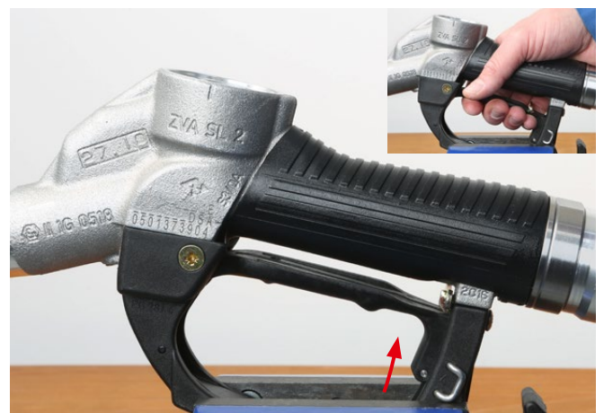
Beim Ziehen des Schalthebels ist die Zugkraft der Hauptfeder zu spüren. Während Nachrüstung Schalthebel aufrasten. By pulling the lever you feel the force of the main spring. Keep the lever latched during retrofit.
