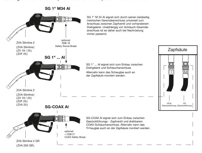
**Hinweis zur Montage**: Bitte Schaugläser mit einem Drehmoment von 25-35 Nm festziehen, wenn diese mit der Schlauchleitung, dem Zapfventil oder der Zapfsäule verbunden werden.
